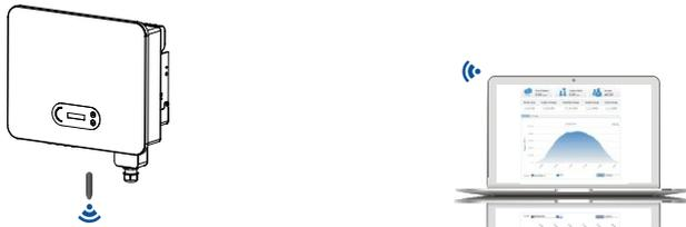
Abbildung 5-21: Anschließen eines USB-Erfassungsticks (WIFI-Version) an den WLAN-Router
