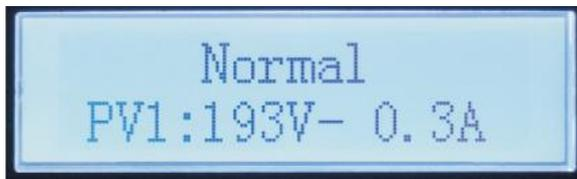
Betriebszustand des Wechselrichters, erzeugte PV-Leistung
