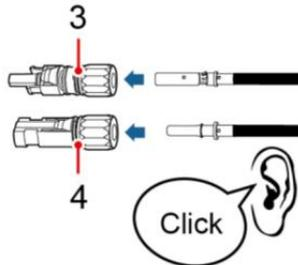
Abbildung 5-13: Anschluss des Gleichstromkabels (3)
