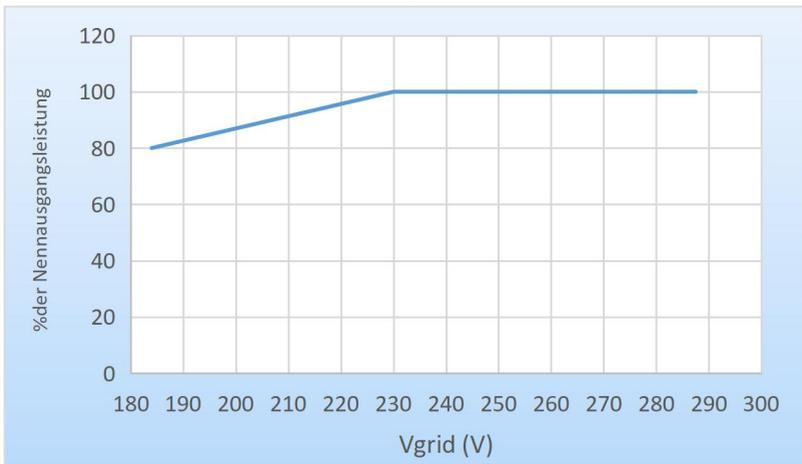
Abbildung 2-10 Verhältnis der Nennleistung zur Netzspannung
