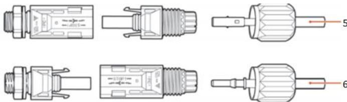
Abbildung 5-14 DC-Kabelanschluss(4)
