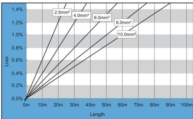
Abbildung 5-6 Verhältnis zwischen Kabellänge, Querschnittsfläche und Verlustleistung
