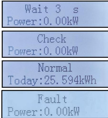
Wechselrichterzustände: Warten, Prüfen, Normal und Fehler
