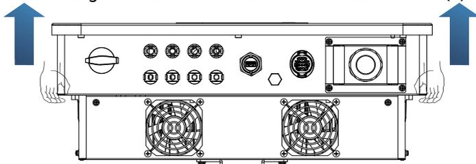
Abbildung 4-5 Wechselrichter aus dem Gehäuse nehmen (2)
