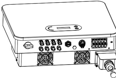
Abbildung 5-8: Schema zum Entfernen der wasserdichten AC-Abdeckung.
