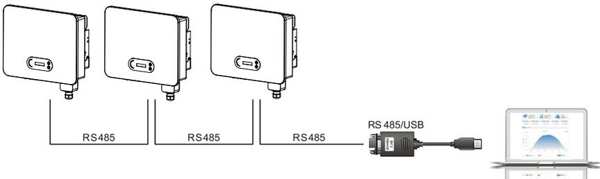
Abbildung 5-20: Multi REFUSOL 20K-2T (853P020.000) Anschluss Kommunikation. Registrieren Sie die Fernüberwachung des REFUSOL 20K-2T (853P020.000) auf der entsprechenden Website oder APP entsprechend der SN des Überwachungsgeräts.
