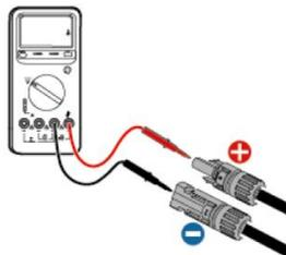
Abbildung 5-15 Verwenden Sie ein Multimeter, um die positiven und negativen Elektroden zu überprüfen.
