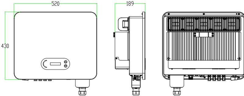
Abbildung 2-3 Vorder-, Seiten- und Rückseite des Wechselrichters
