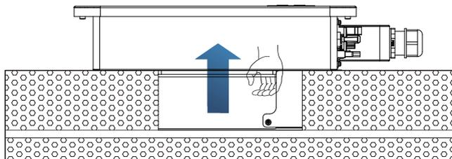
Abbildung 4-4 Wechselrichter aus dem Gehäuse nehmen (1)
