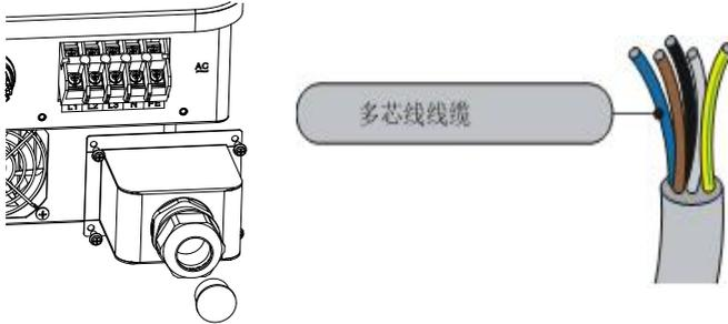
Abbildung 5-7 REFUSOL 20K-2T (853P020.000) Abbildung des AC-Anschlusses
